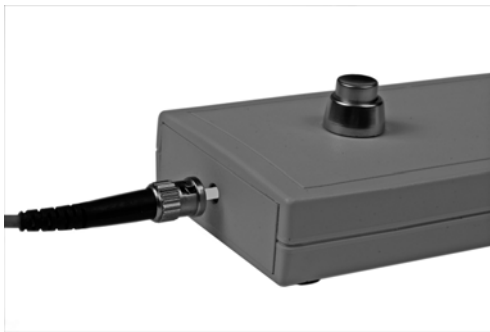
Abbildung 2.41 Eigenbau-LWL-Tester mit Adapterkabel ST
