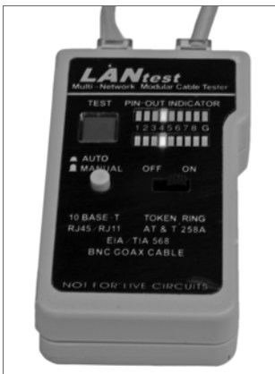
Abbildung 2.26 Prüfung der Patchkabel
