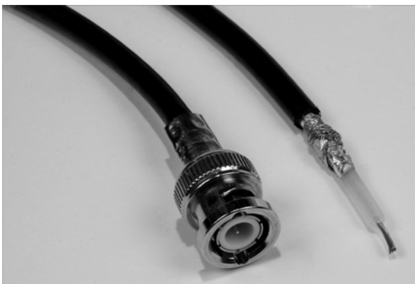
Abbildung 2.2 BNC-Stecker und Koaxialkabel Cheapernet (10Base-2)
