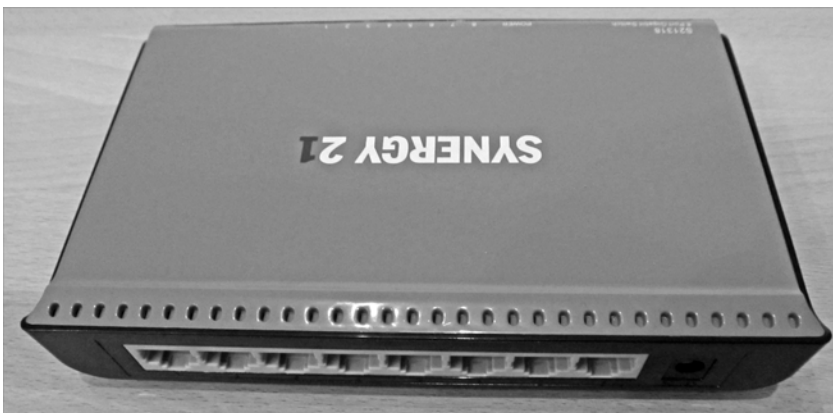
Abbildung 10.11 Tisch-Switch S21318 der Firma Synergie 21, ohne Management-Modul
