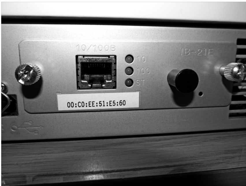
Abbildung 4.1 Aufkleber mit MAC-Adresse an einem internen Printserver
